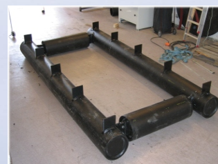
NOFI BYGGESETT klar for montering av dekke.
